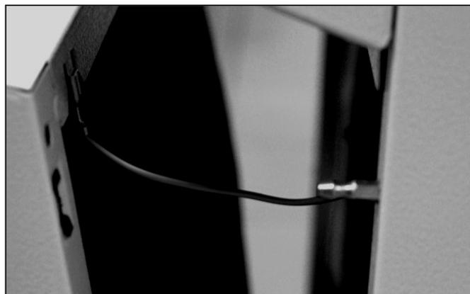
Abb. 26: Schutzleiter zwischen Frontverkleidung und Verkleidungsdeckel
